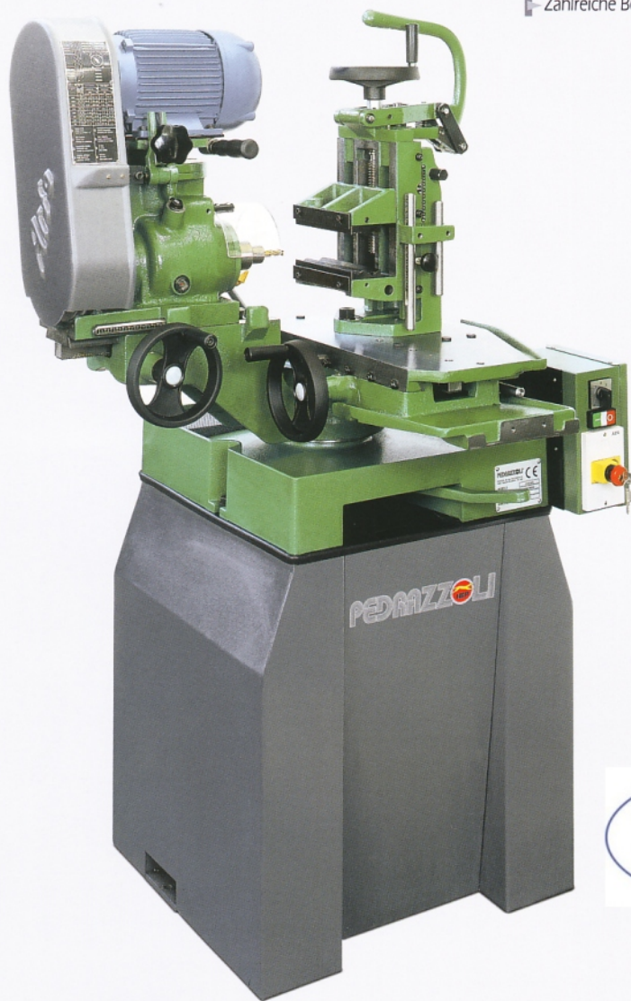
Maschine in Normalstellung zur Herstellung von Langlöchern in Profilen. Es können Arbeitsgang gefräst werden, ausreichend für die gängigsten handelsüblichen Schloss-Stulpe.
